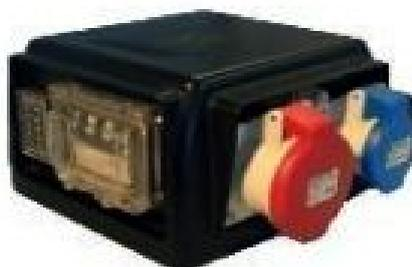
1 presa CEE 230 V monofase 3 poli 16A con breaker di protezione, 1 presa CEE 400 V trifase 5 poli 32A con interruttore magnetotermico di protezione e voltmetro a led.
